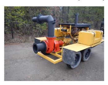
Inlet: 10"Discharge: 8"Impeller: 12"
