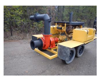
Inlet: 10"Discharge: 8"Impeller: 12"
